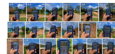
Figura 1. Mediciones en campo de irradiancia
